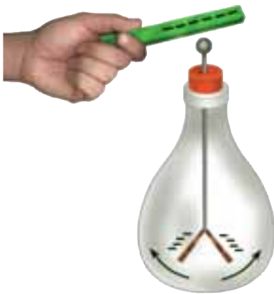
Figura 3. En el electroscopio al acercar un cuerpo cargado, las laminillas se separan al quedar cargadas con el mismo tipo de carga.
