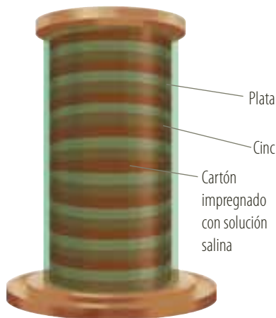
Figura 2. La pila eléctrica de Alessandro Volta, es la primera fuente de corriente eléctrica sin interrupción.
