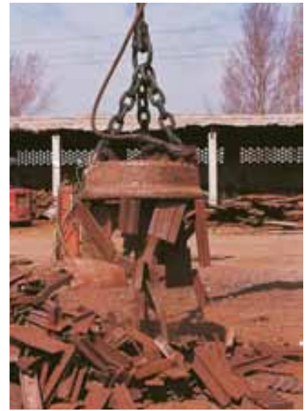
Figura 7. Los electroimanés tienen diferentes aplicaciones como el traslado de objetos pesados de hierro.
