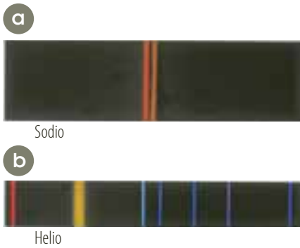
Figura 11. Espectroscopio de emisión, con el que se identifica el espectro de cada sustancia y que puede ser continuo como el del sodio o discontinuo como el del helio.
