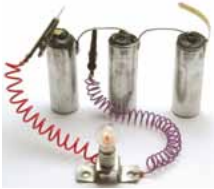
Figura 7. Un circuito eléctrico está formado por un generador de corriente eléctrica y por los receptores.
